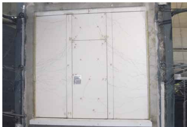
Um die Feuerwiderstandsklasse zu ermitteln, wurde in einem Prüflabor eine Wandseite der Variflex EI 30 mit integrierter Durchgangstür über eine halbe Stunde lang direktem Feuer ausgesetzt.
